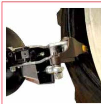
**IT** Dettaglio utensile completo di protezione in plastica fornito in dotazione
