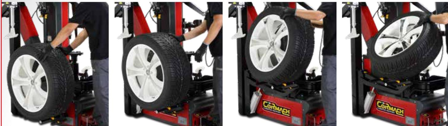
**IT** Dispositivo pneumatico per il sollevamento della ruota con comandi a pedale. Consente il corretto posizionamento sull'autocentrante di tutte le ruote, senza sforzo per l'operatore.
