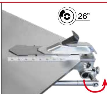
**IT** Regolazione manuale delle griffe per bloccaggio da 24" a 26".
