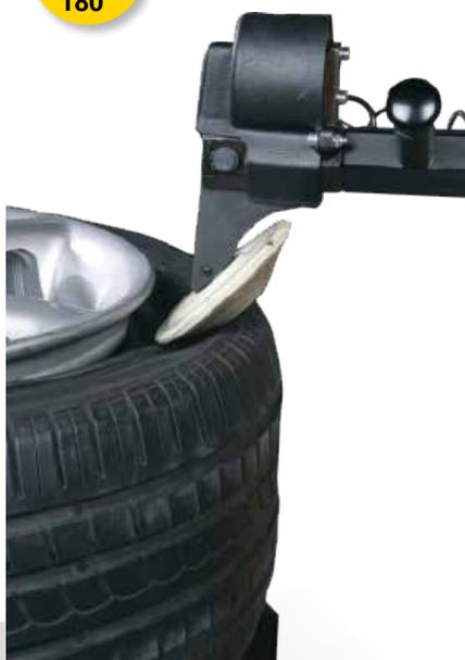
**IT** Stallonatore pneumatico monobraccio a disco telescopico. Questo sistema di stallonatura, composto da un unico braccio, prevede l'utilizzo di un apposito disco ribaltabile a 180° attraverso il quale è possibile stallonare entrambi i fianchi del pneumatico. Con questo sistema, la stallonatura avviene in modo rapido, preciso e sicuro anche sulle ruote più impegnative e dure.
