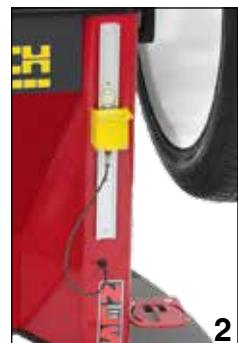
**IT** Sensore sonar radiale (1) e laterale (2) per la misurazione dei valori di eccentricità.
