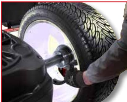
**IT** Nuovo sistema di acquisizione dei dati ruota tramite accelerometro. Più veloce, senza manutenzione.
